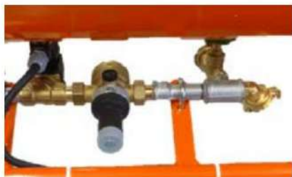
Figura 4: Conexão de água
